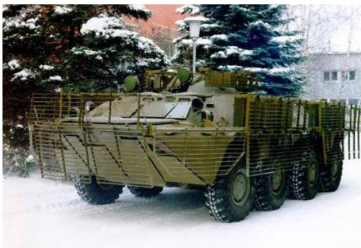
Рисунок 3 – БТР оборудованный решётчатыми экранами
