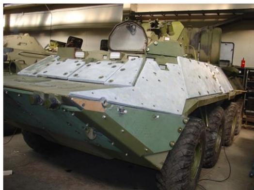
Рисунок 2 – Оборудование БТР дополнительной броней из сверхвысокомолекулярной (СВМ) ткани
