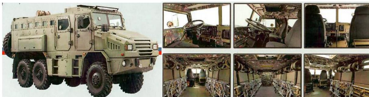
Рисунок 2 – Автомобиль специальный бронированный ФЕДЕРАЛ-М
