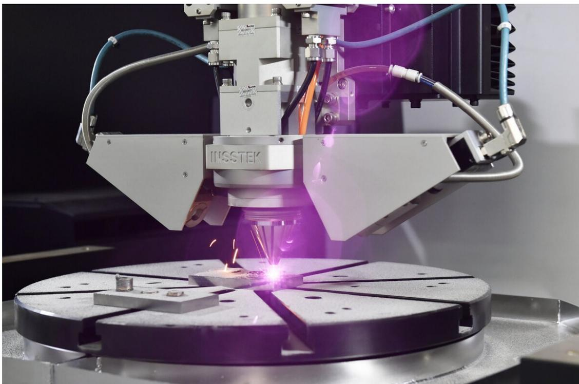
Рисунок 1 – Создание изделия путем лазерного плавления в порошковом слое
