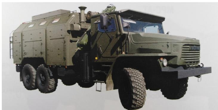
Рисунок 3 – Мастерская ремонта и технического обслуживания МРТО-АТ1
