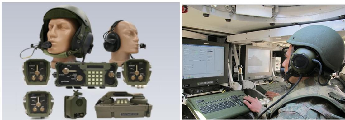
Рисунок 6 – Цифровая автомобильная система связи ICS-6680
