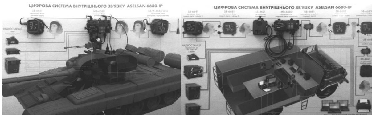
Рисунок 8 – Состав цифровой системы внутренней связи ASELSAN 6680-IP
