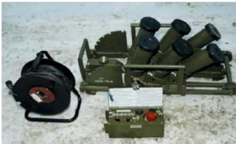
Рисунок 10 - Многозаровая многоствольная пусковая установка с электрической системой запуска (ГНОМ-УМ-6)
