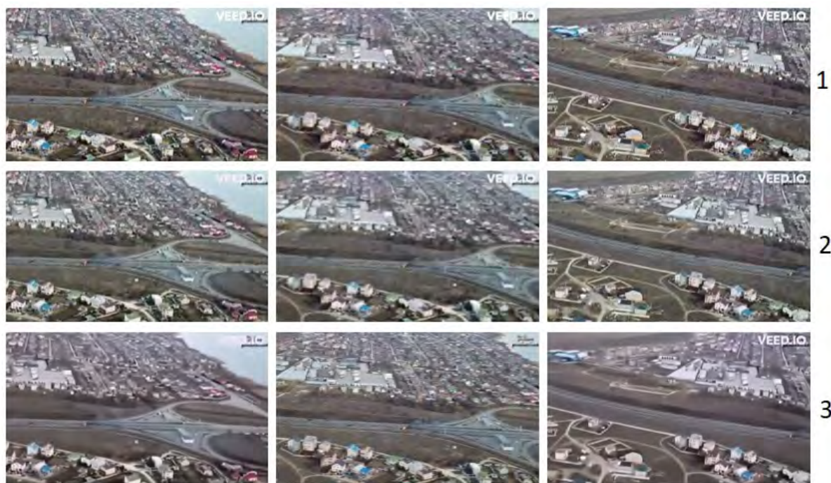
Рисунок 1 - Применение комбинированного фильтра на видеопоток с беспилотного летательного аппарата. (1 - исходные кадры; 2 – кадры, полученные после применения оператора Лапласа, 3 – кадры; полученные после применения вейвлет – признаков Козна-Добеши-Фово)
