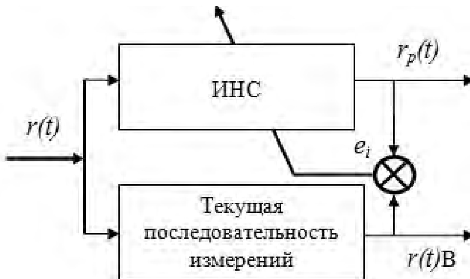
Рисунок 4 – Схема с ИНС для восстановления утраченной информации
