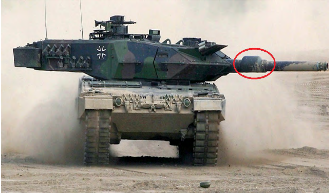
Рисунок 4 – Эжектор на стволе танка Leopard 2
