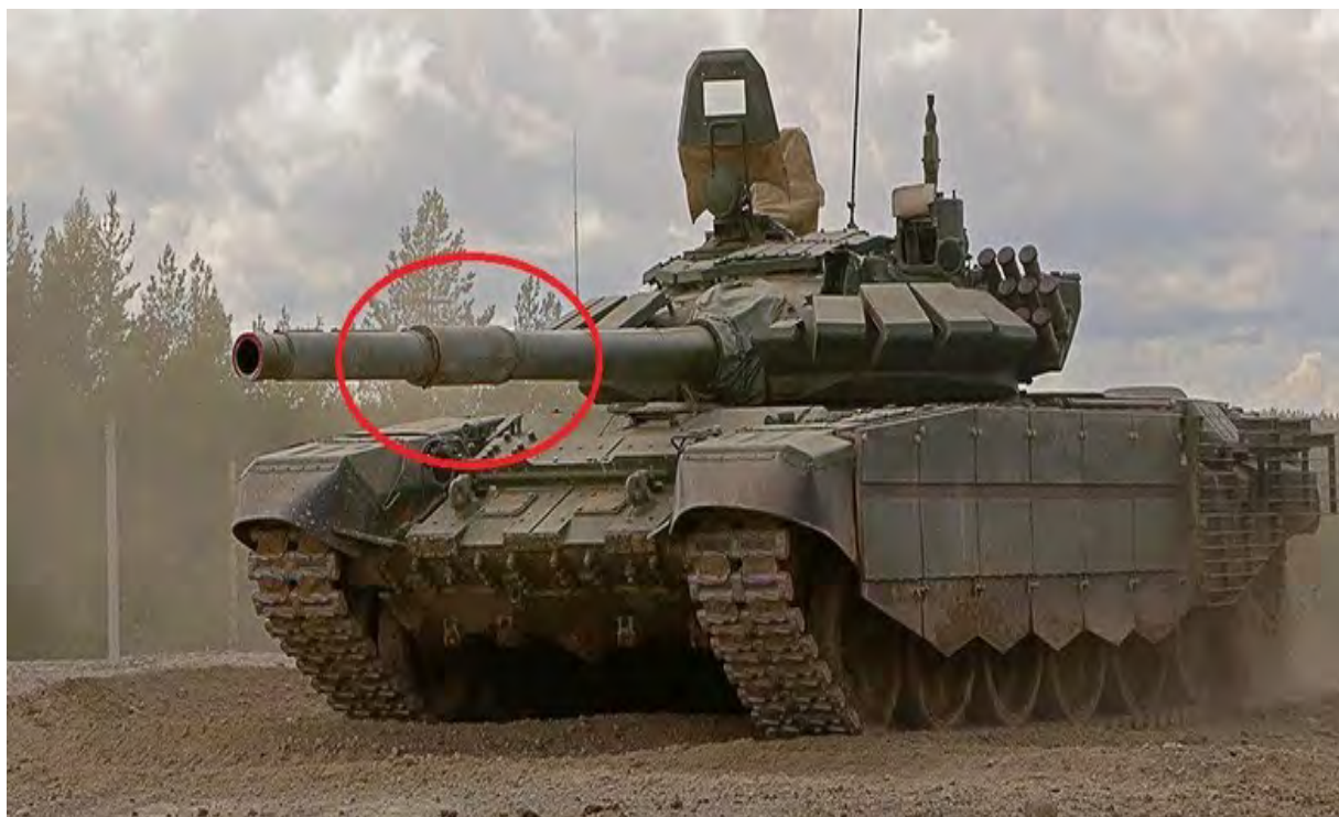
Рисунок 3 – Эжектор на стволе танка Т-90
