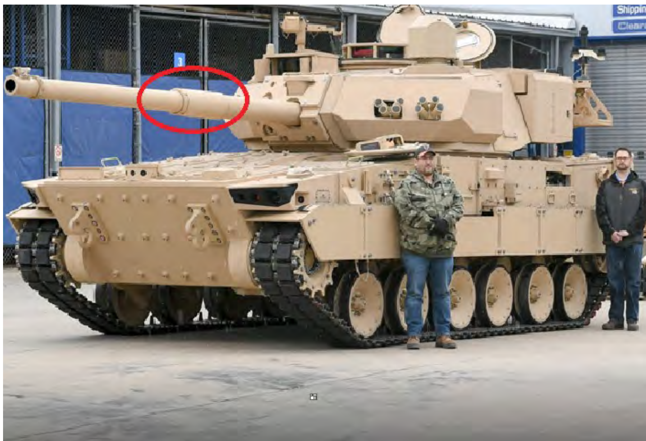
Рисунок 1 – Танк MPF с видимой частью эжекционной системы
