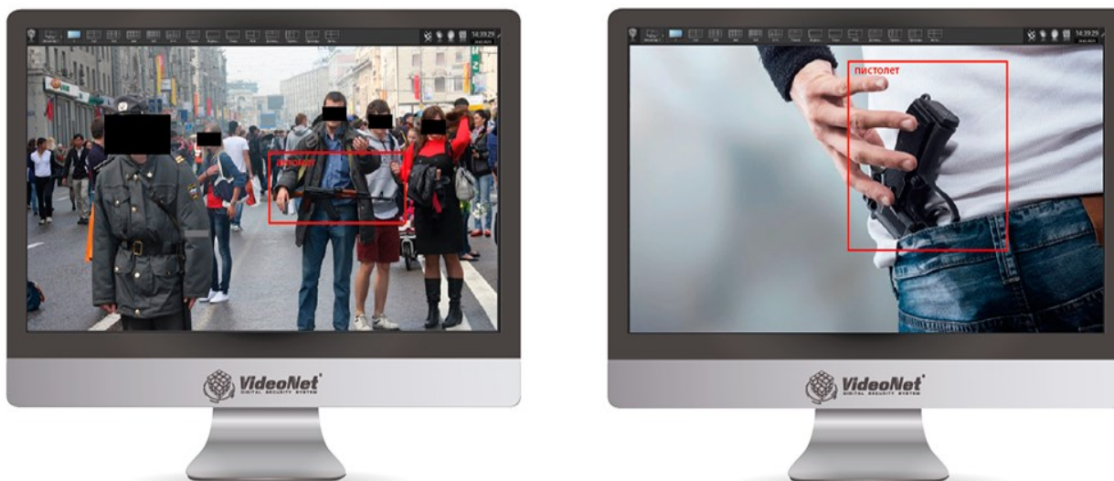
Рисунок 9 – Изображение на мониторе от нейросетевого детектора оружия Детектор скрытия лица (Рисунок 10) – позволяет зафиксировать умышленное скрытие лица.
