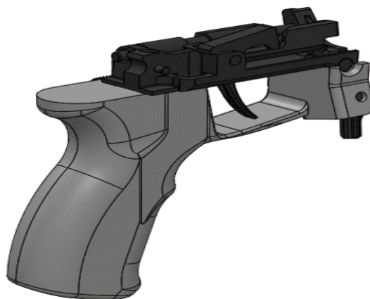
Рисунок 5 – Модернизированная конструкция спускового механизма автомата АН-94
