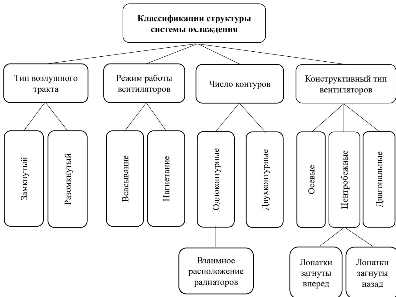
Рисунок 1 – Классификация структуры вентиляторных систем охлаждения
