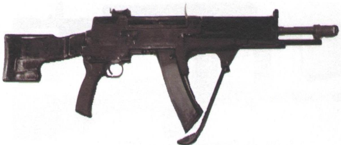
Рисунок 1 – Опытный автомат АС варианта 1986 г. конструкции Г.Н. Никонова
