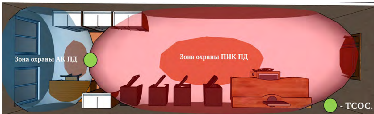
Рисунок 15 – Зона охраны предлагаемого комбинированного технического средства охранной сигнализации в удлиненном помещении
