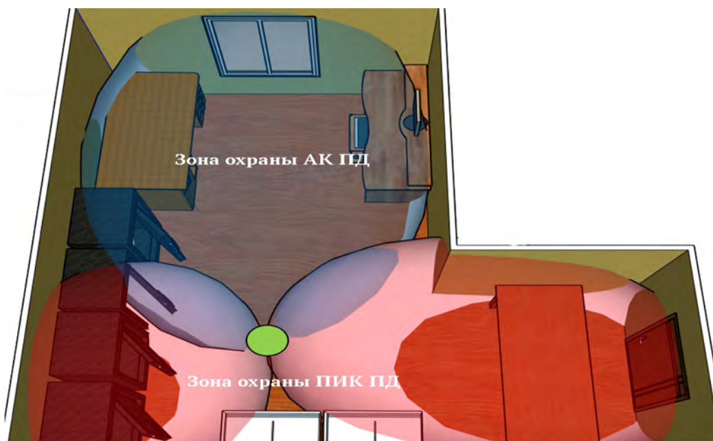
Рисунок 14 – Зона охраны предлагаемого комбинированного технического средства охранной сигнализации на важном объекте сложной конструкции
