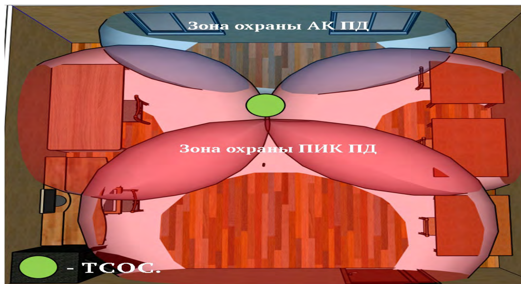
Рисунок 12 – Зона охраны предлагаемого комбинированного технического средства охранной сигнализации
