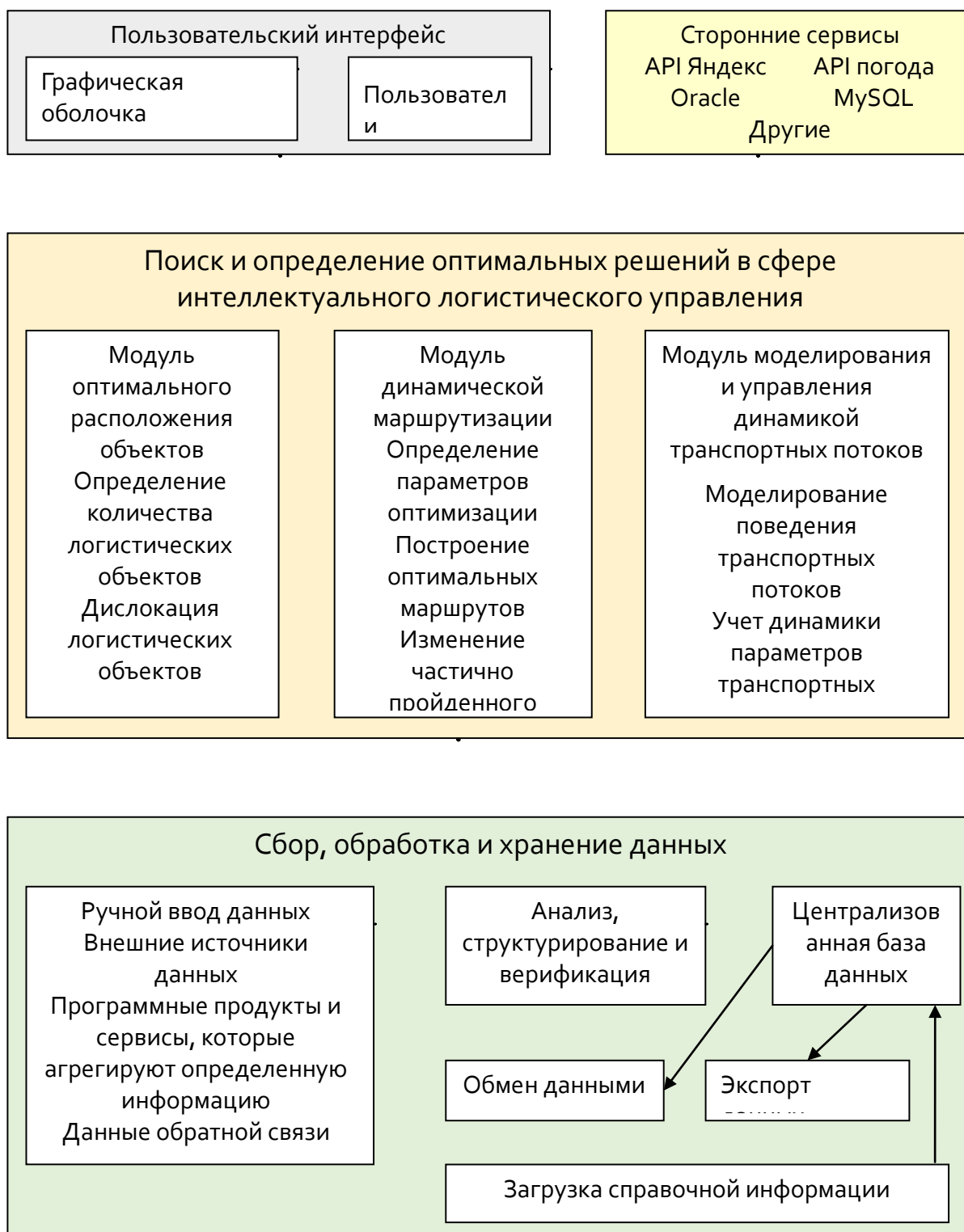
Рисунок 2 – Многоуровневая логическая архитектура системы поддержки принятия решений органами управления интеллектуальной транспортно-логистической системы материального обеспечения войск (сил)
