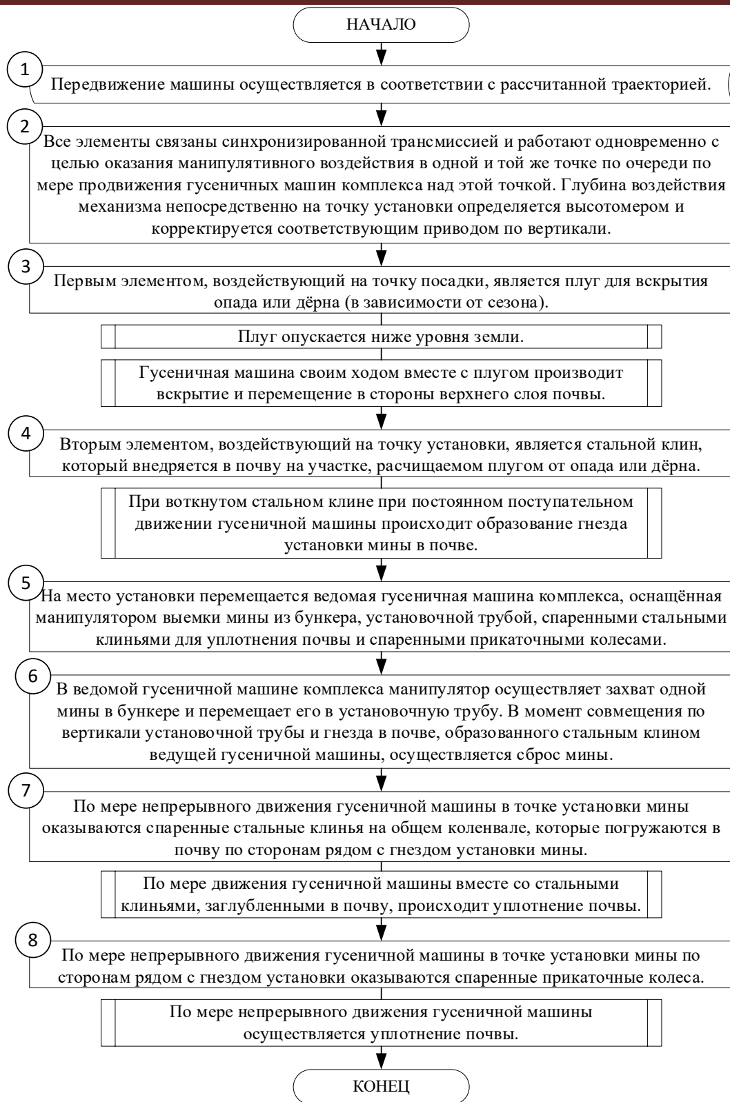
Рисунок 3 – Блок-схема алгоритма работы комплекса работа-минёра
