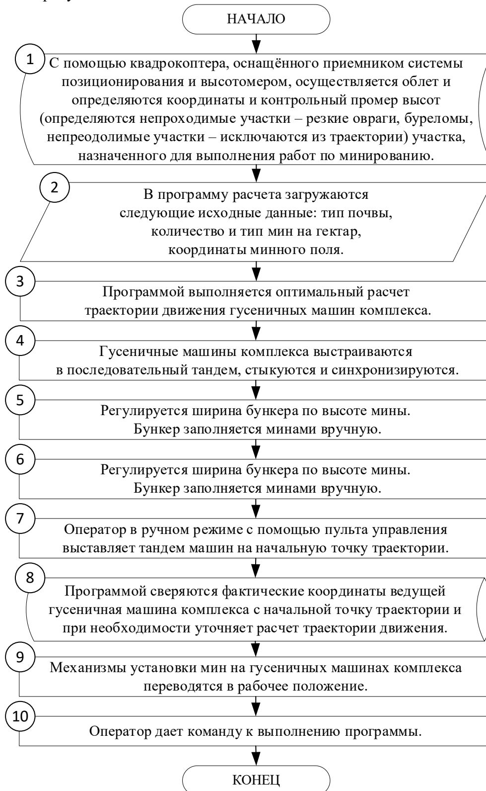
Рисунок 2 – Блок-схема алгоритма подготовки комплекса робота-минёра к выполнению работ
