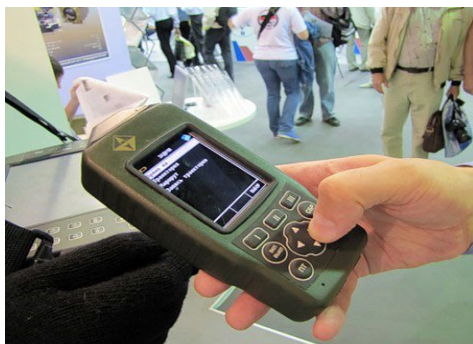
Рисунок 6 – Портативный многоцелевой приемоиндикатор НПИ 2
