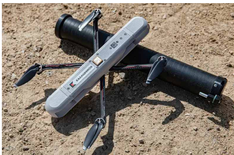
Рисунок 3 – БПЛА мини-класса «Каракурт» и транспортно-пусковое устройства (тубус)
