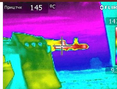
Рисунок 3 – Температурные нагрузки в стволе при использовании патрона с композитной гильзой
