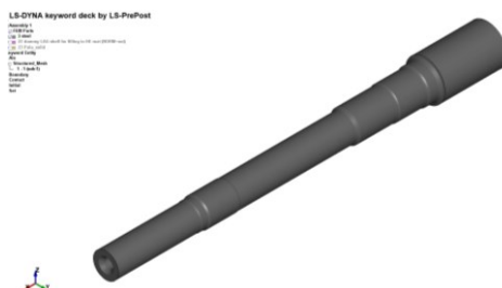
Рисунок 2 – Модель ствола 5,45-мм автомата Калашникова
