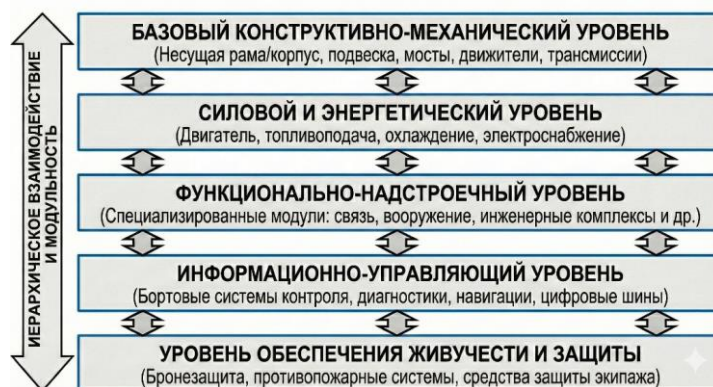
Рисунок 1 – Общая уровневая архитектура военной автомобильной техники специального назначения
