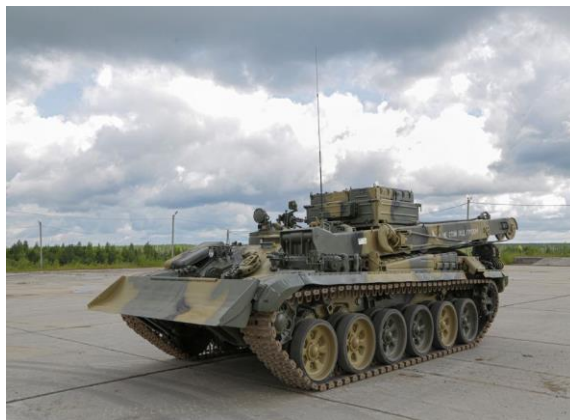
Рисунок 1 – Бронированная ремонтно-эвакуационная машина БРЭМ-1 на базе танка Т-72т
