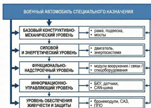
Рисунок 2 – Декомпозиция конструкции военного автомобиля по архитектурным уровням
