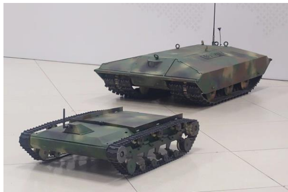
Рисунок 2 – Беспилотная платформа для эвакуации раненых
