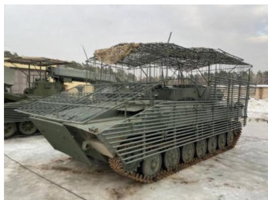
Рисунок 3 – Применение дополнительной защиты на бронетанковой технике
