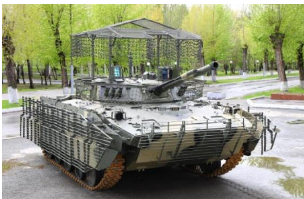
Рисунок 3 – Применение дополнительной защиты на бронетанковой технике
