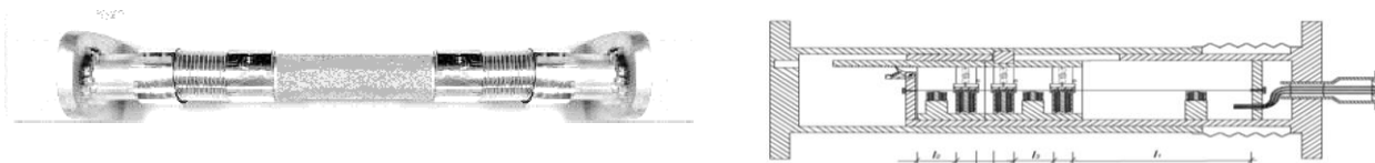
Рисунок 9 – СП с переменной длиной струны, по патенту №777515
