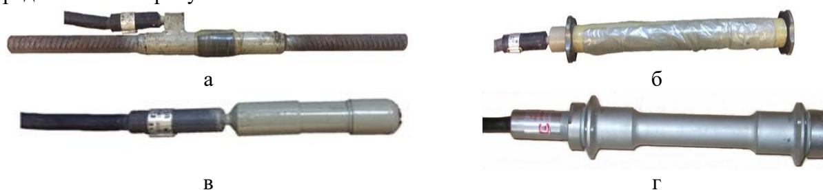
Рисунок 2 – Струнные преобразователи, выпускаемые в России:
