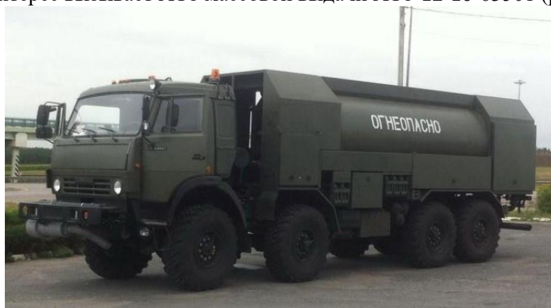
Рисунок 1 – Автотопливозаправщики массовой выдачи АТЗ-12-10-63501
