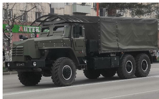
Рисунок 2 – Автотопливозаправщик АТЗ-8-4320М на шасси Урал-4320-40
