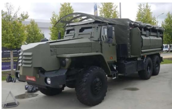
Рисунок 2 – Автотопливозаправщик АТЗ-8-4320М на шасси Урал-4320-40
